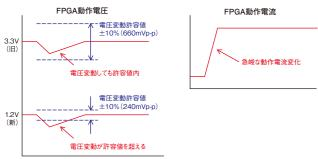
IC動作電圧の低電圧化により、誤動作のリスクが高まる
