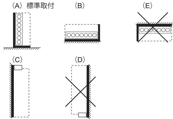
電源を装置に実装する場合、標準取付 (A)以外に、上記の(B)~(F)がありますが、(D),(E)の取付は電源内部に熱がこもるため、使用不可です。(A)及び(B),(C)の取付は出力ディレーティングカーブ以内で使用ください。
