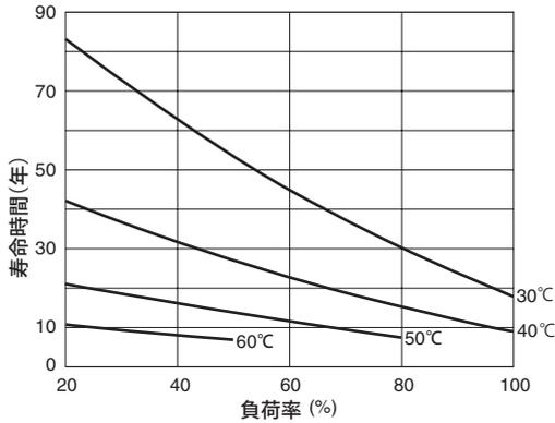
AC.200V系 電解コンデンサ寿命 (標準取付)
